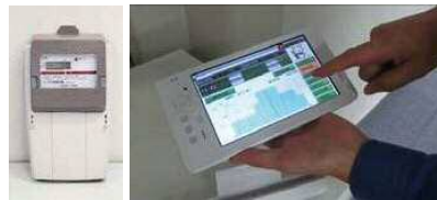
地域の住宅に導入したスマートメータ（左）と宅内表示器（右）
