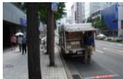
ベイ：バス、客待ちタクシーや貨物車両のために車道の脇に設置された停車場。路上駐車を無くすることで、円滑な自動車交通を確保する。写真は荷捌きベイ
