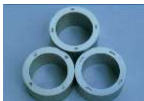
電磁鋼板：モーターや変電装置等の高効率化に寄与
