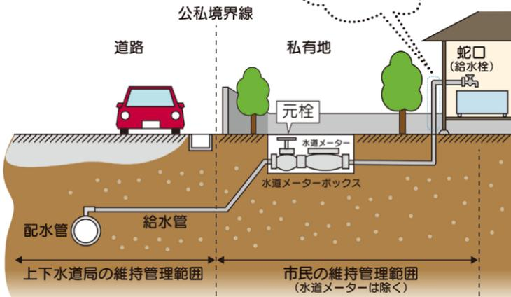
2. 水道メーターのパイロットが回っていれば宅内で漏水している可能性があります。
