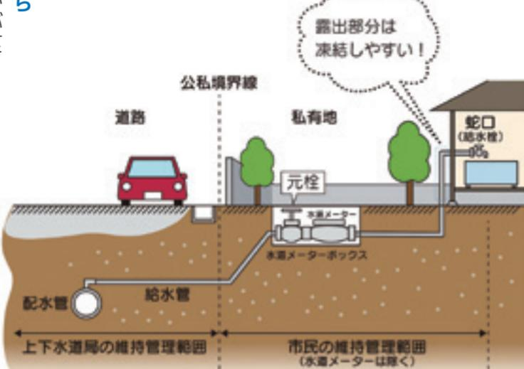
2. 水道メーターのパイロットが回っていれば宅内で漏水している可能性があります。
