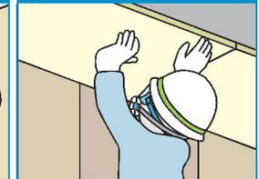
吹付けアスベスト等の層を残したまま、板状の材料等で覆うことで、粉じんの飛散や損傷等の防止を図る工法。除去工法より安価ですが、建物の解体時などには、除去工事が必要になります。
