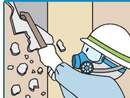
吹付けアスベスト等そのものを取り除く方法。アスベスト含有建材が完全に除去されるので、大地震の際にも剥落するおそれなくなり、最も確実に建物を安全にする工法です。
