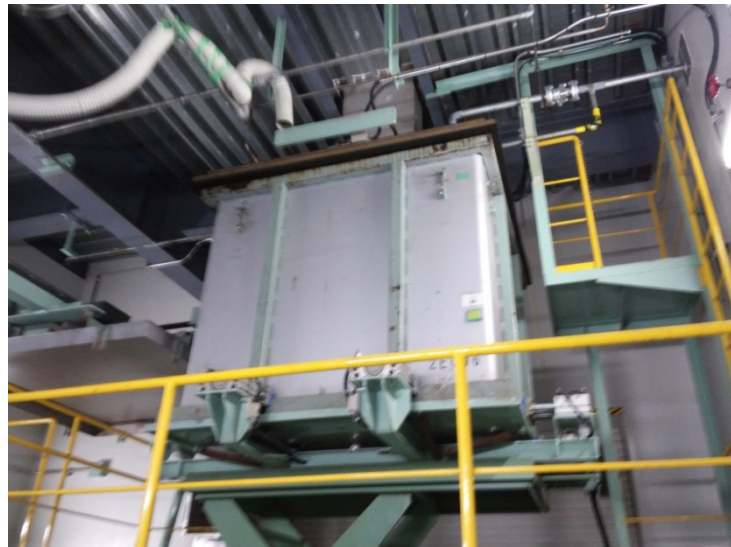
固形物充填槽が蓋と密着した様子 (充填後、左の鉄蓋で蓋がされる)
