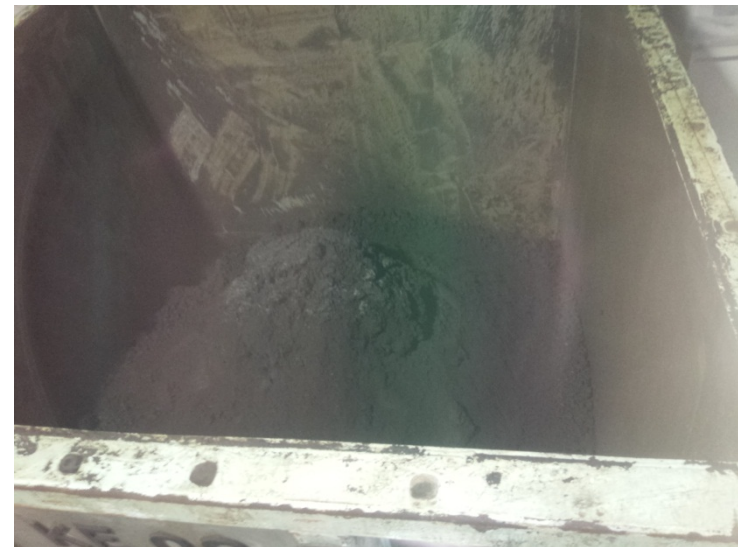
固形物充填槽内の固形物 (写真は1期施設のもので、2期施設のものより乾燥している)
