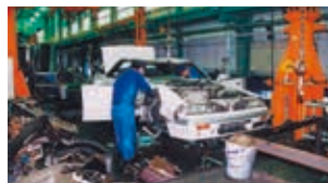
自動車リサイクル事業 「自動車リサイクル法」に基づく自動車解体業。自動車メーカーから精緻な解体を委託され、解体後は廃自動車を鉄鋼原料として転炉に投入するなど高度なリサイクルを行う。全部再資源化認定（法第31条認定工場）。 ■事業主体 西日本オートリサイクル㈱
