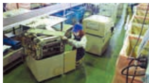
OA機器リサイクル事業 使用済みのOA機器（コピー機、ファクシミリ、プリンター、パソコン）を分解し、新たな機器の部品やプラスチック、アルミ、鉄などを回収してリサイクルする。 ■事業主体 ㈱リサイクルテック
