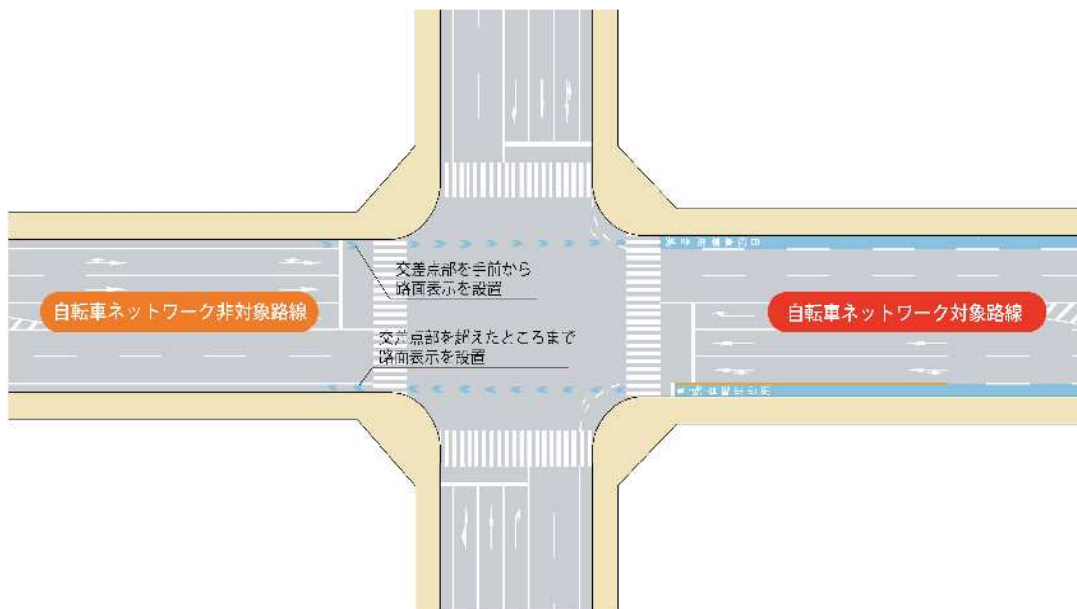
■ネットワーク端部の交差点部の路面表示方法の例
