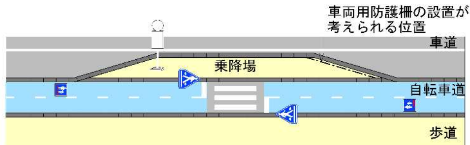
■車道と自転車道との間に交通島のバス停留所を設置するイメージ《テラス型》 （バス交通が多く道路空間に余裕がある路線）
