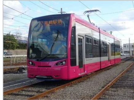
■筑鉄新型低床式LRT
