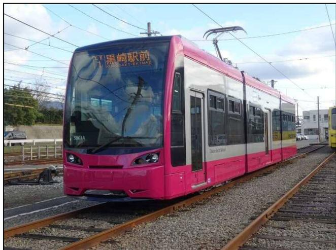
■写真一1 LRT型低床車両
