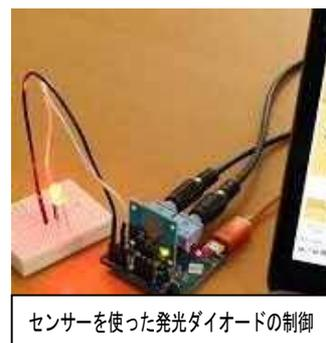
センサーを使った発光ダイオードの制御
