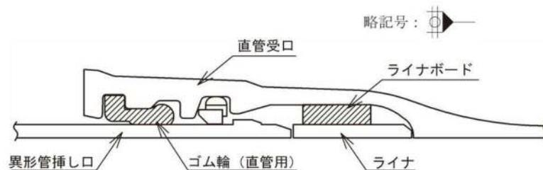
図3-7-19 直管の継手構造 (ライナ使用)
