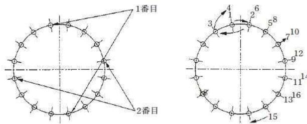
図3-7-25 仮締め付け      3-7-26 追い締め付け
