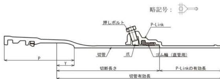
図3-7-21 P-Linkの構造
