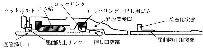
図3-7-7 異形管の継手構造(呼び径75~250)
