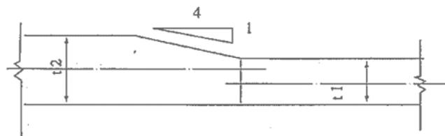
図 3-8-3 管厚の異なる溶接継手
