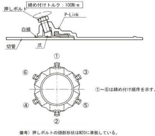
図3-7-22 押ボルトの締め付け順序
