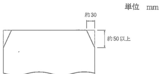
熱収縮シートと工場塗覆装部との重ね長さは、両側とも  $50\text{ mm}$  以上とする。なお、熱収縮シートの円周方向の重ね長さも  $50\text{ mm}$  以上とする。
