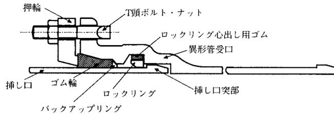
図3-7-8 異形管の継手構造(呼び径300~450)
