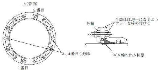
図3-7-15 ボルト・ナットの締め付け
