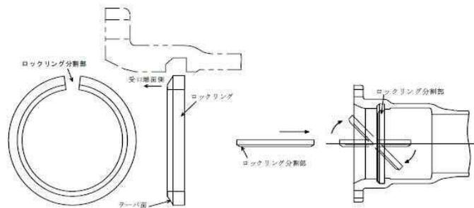
図3-7-13 ロックリングの受口へのセット方法
