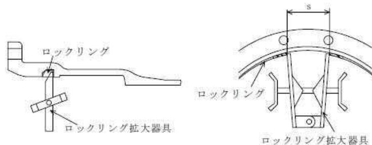
図3-7-14 ロックリング拡大器具の装着
