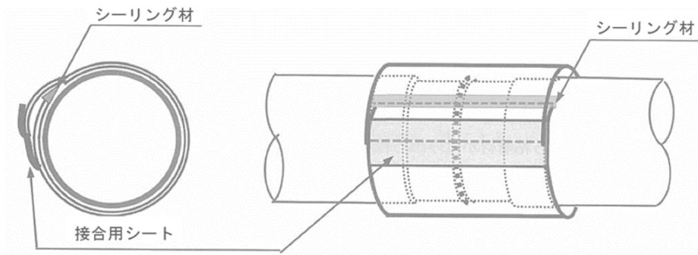
図 3-8-6 熱収縮シート巻き終わり部の施工
