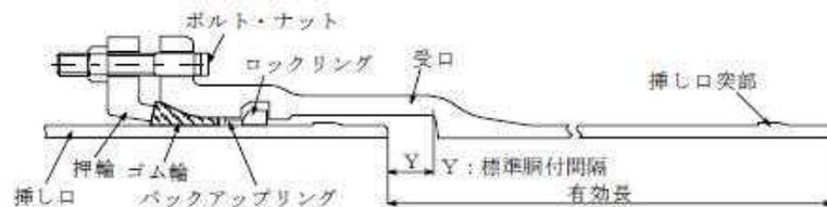
図3-7-10 直管の継手構造(呼び径500~1000)
