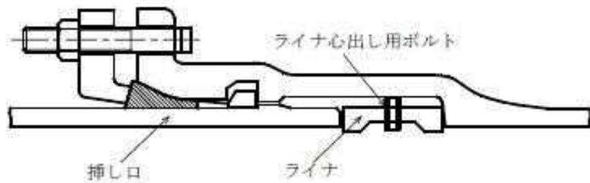
図3-7-12 直管の継手構造（ライナ使用）
