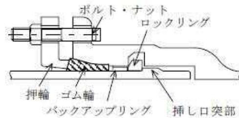
図3-7-17 異形管の継手構造 (呼び径500~1000)
