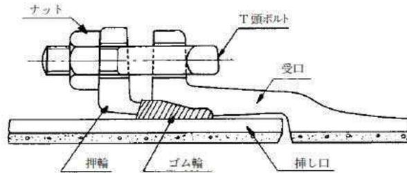
図3-7-1 継手構造
