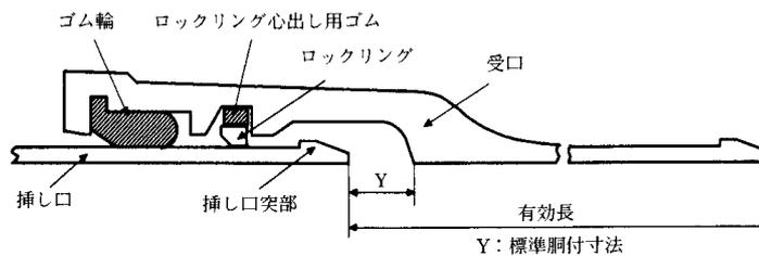
図3-7-5 直管の継手構造(呼び径75~450)
