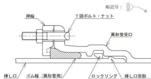
図 3-7-20 異形管の継手構造
