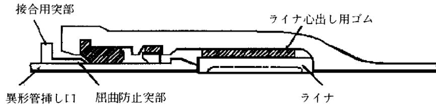
図3-7-6 直管の継手構造(呼び径75～450ライナ使用)
