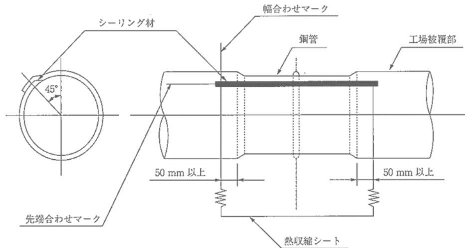
図 3-8-5 熱収縮シートの巻付け
