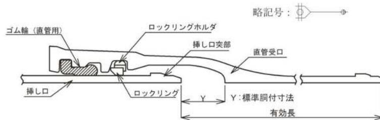
図3-7-18 直管の継手構造
