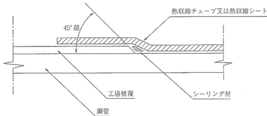
図 3-8-4 シーリング材の施工
