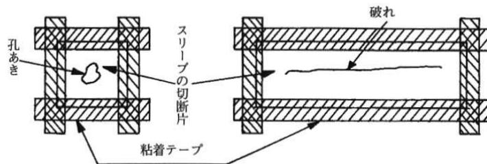
図 3-6-3 スリーブの補修
