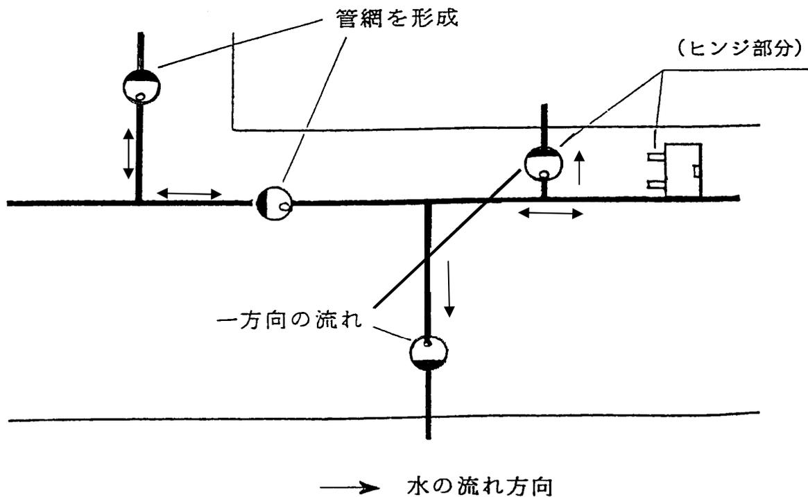
図3-9-1 水の流れによる設置方法
