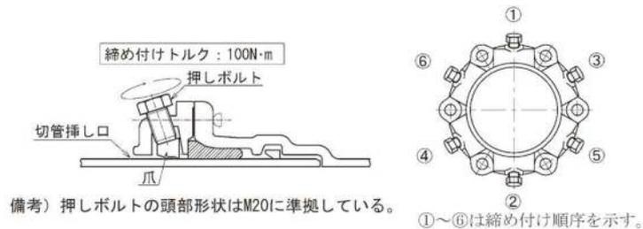
図3-7-24 押しボルトの締め付け順序
