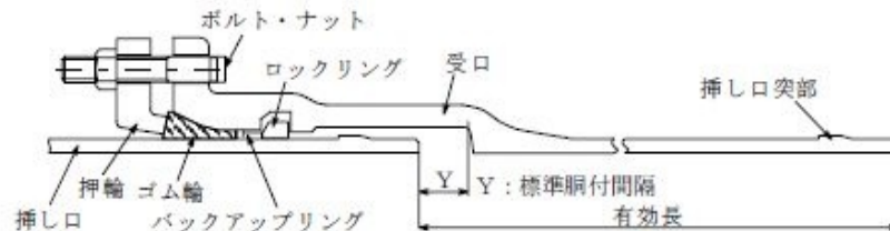
図3-7-21 直管の継手構造(呼び径500～1000)
