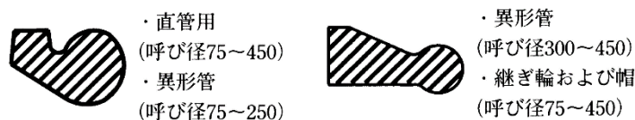
図3-7-17 ゴム輪の断面形状
