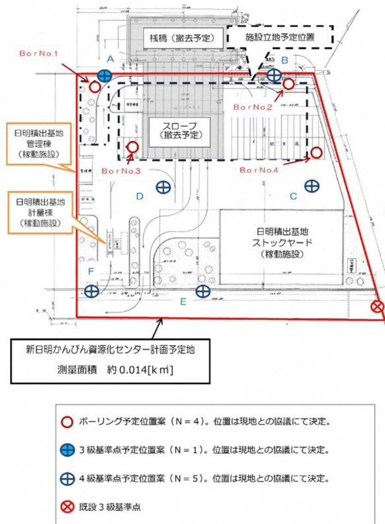
図 ボーリング地質調査・測量基準点位置図
