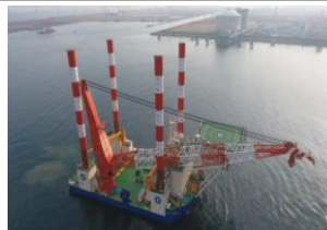
北九州港を母港とする特殊作業船(SEP) (SEP: Self-Elevating-Platform)
