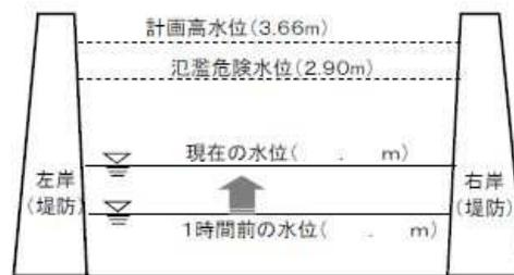
※計画高水位は河川を整備する上での基本となる水位で、計画の洪水を流すことができる最高の水位です。
