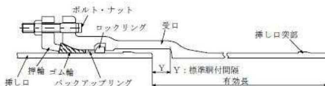
図3-7-21 直管の継手構造(呼び径500~1000)
