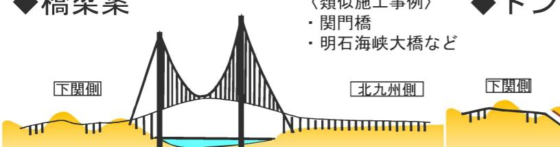
航路幅（約1.2km）以上の支間長が適用できる吊橋を選定
