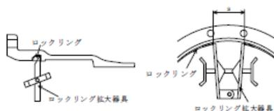
図3-7-25 ロックリング拡大器具の装着
