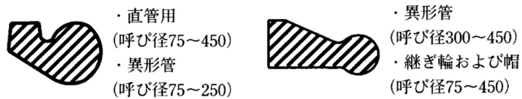
図3-7-17 ゴム輪の断面形状
