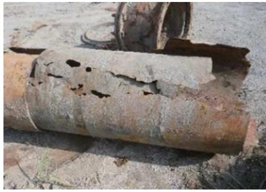
硫化水素により腐食した圧送管
