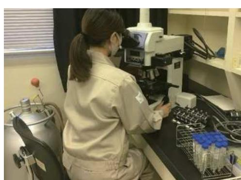
顕微鏡による水質検査
