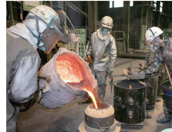
熟練工による銅の溶湯の温度管理
