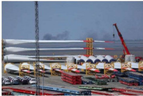
風力発電のブレード
