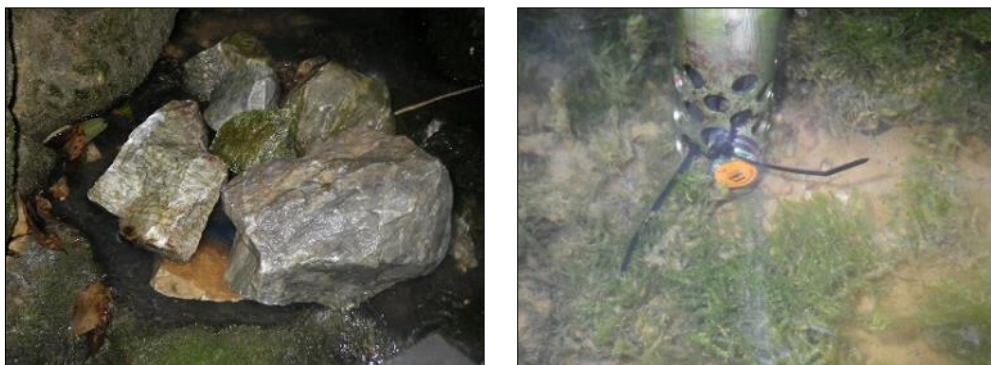
写真 31 水温計の設置状況（左：白谷、右：大清水）
