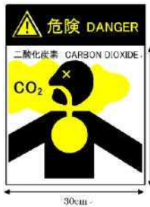
【防護区画の出入口に設ける二酸化炭素の危険性等に係る標識（「二酸化炭素消火設備の設置に係るガイドライン」より）】
