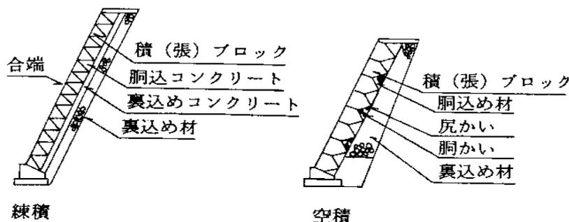
図2-5 コンクリートブロック工
