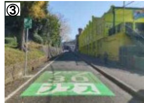
ゾーン30プラス看板・路面表示
