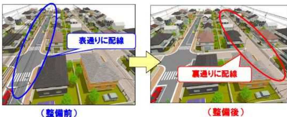
図.5 裏配線方式のイメージ図 (出典：国土交通省ホームページ)
