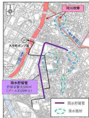
雨水管等の整備
