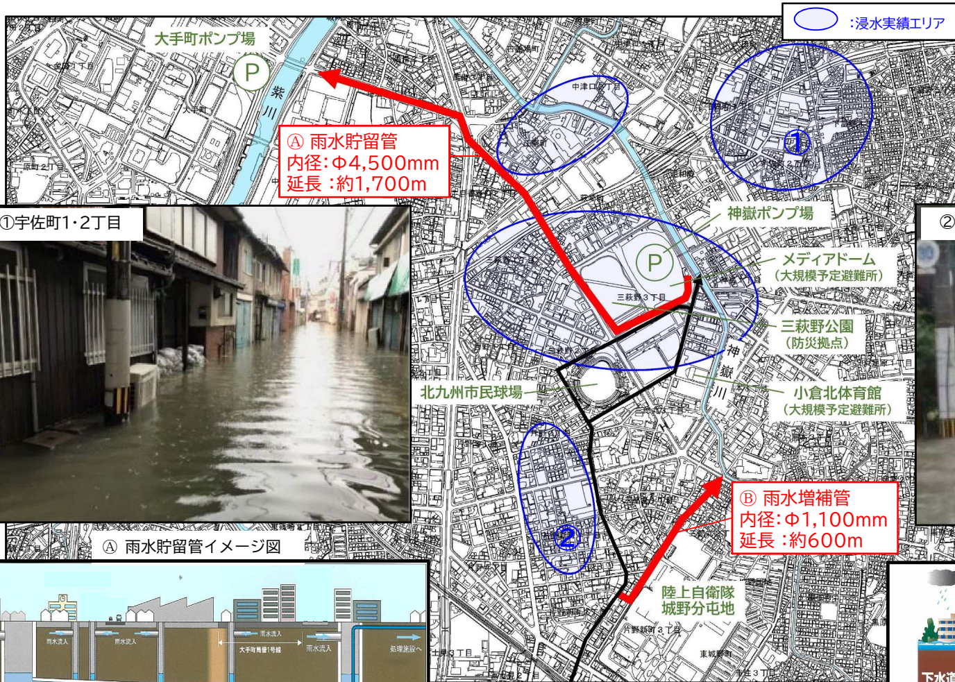
浸水被害 (H30.7.6) 及び浸水対策等箇所図
