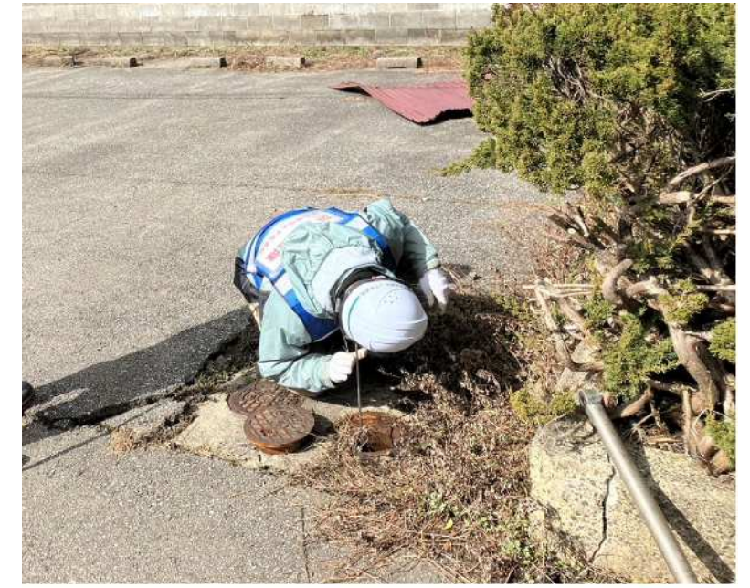
③漏水調査の状況 漏水音を確認する器具(音聴棒)を直接 水道管に当てて漏水調査
