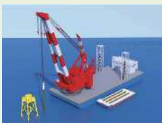
鋼管杭を海底地盤に打設
