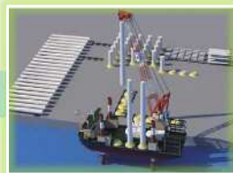
基地港湾にてタワー等を仮組立し、SEP船にて洋上運搬
