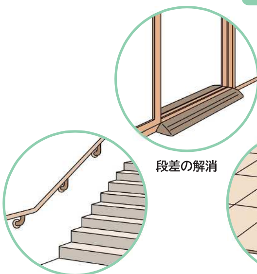
手すりの設置
