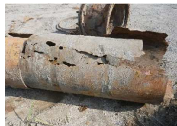
硫化水素により腐食した 下水道管渠（圧送管）
