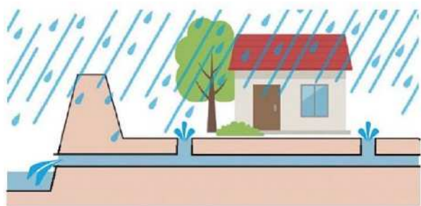
①短時間に激しい雨が降ることで、排水が間に合わずに発生する氾濫
