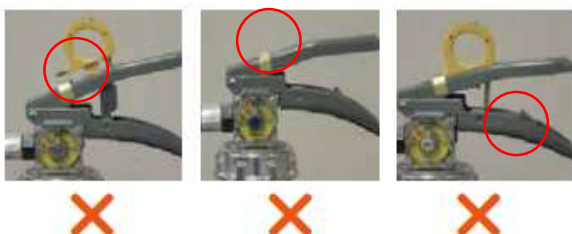
安全栓の抜けかけ 安全栓の脱落 ｵﾊﾞｰ支えの脱落
