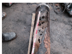
老朽化し穴の開いた水道管
