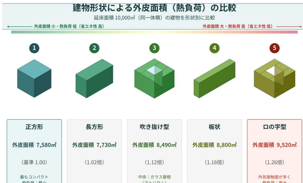
図 1.3-1 建物形状による外皮面積(熱負荷)の比較
