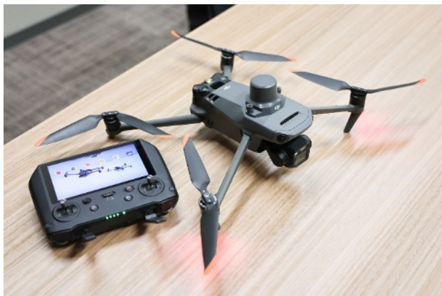
ICT 測量に活用するドローン
