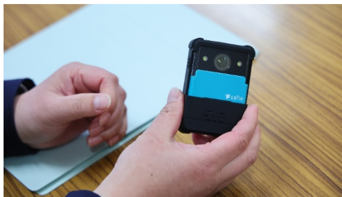
リモート現場管理システムに使用するカメラ
