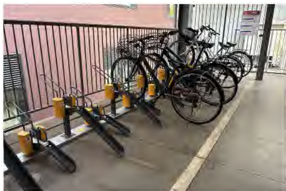
自動入庫機器（個別ロック式）の導入例
