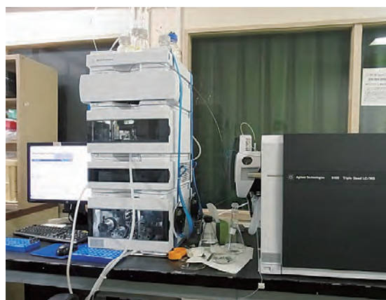
食品の検査に用いる機器（LC/MS/MS）
