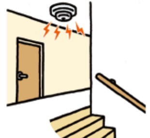
寝室がある階の階段上部
