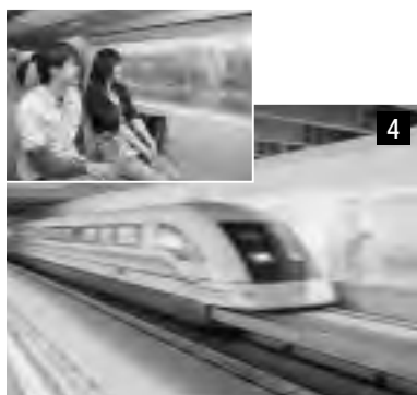
▲リニアモーターカー 実用として運行されているのは世界でも上海だけ。最速431km/hで、浦東国際空港～龍陽路駅（地下鉄）の約30kmを8分で結ぶ。
