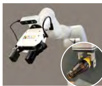
＜Quick Factory＞ (クイックファクトリー) カメラ付きのロボットアームを 備えたシステム
